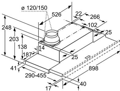
Tiefenanpassung des Filterauszuges bis 29 mm möglich
