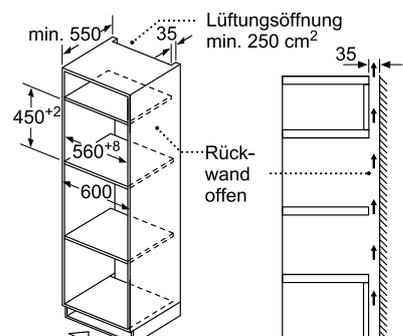
Belüftung im Sockel min. 50 cm<sup>2</sup>
