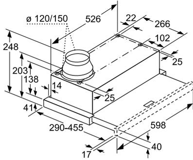
Tiefenanpassung des Filterauszuges bis 29 mm möglich
