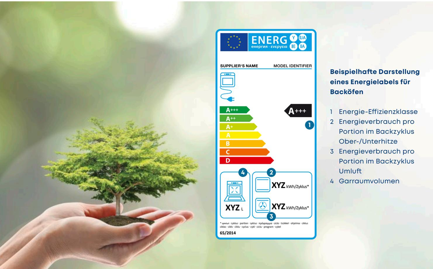
**Beispielhafte Darstellung eines Energielabels für Backöfen**
