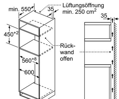
Belüftung im Sockel min. 50 cm<sup>2</sup>
