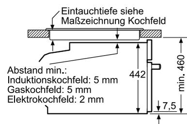
Wird das Kompaktgerät unter einem Kochfeld eingebaut, muss folgende Arbeitsplattenstärke (ggf. inkl. Unterkonstruktion) beachtet werden.
