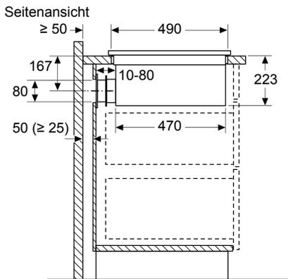
Bei der Installation direkt an einer nicht isolierten Außenwand ( $\mu \geq 0,5 \text{ W/m}^2 \text{ } ^\circ\text{C}$ ) empfehlen wir die Verwendung von Konfigurationen mit teilweise oder vollständig kanalisierter Rezirkulation.
