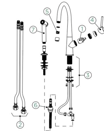
Hinweis: Mit Hilfe eines Bajonett-Verschlusses kann die Altos W umgelegt werden. Je nach Hebelposition variiert die Höhe der Armatur in liegender Position zwischen 45 mm und 54 mm.
