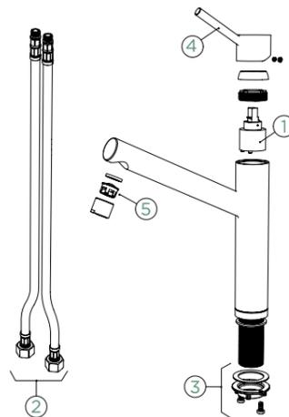
Hinweis: Diese Explosionszeichnung bildet die Hochdruck-Armatur mit deren Ersatzteilen ab. Für die Niederdruck-Armatur finden sie die Ersatzteilnummern in der Anleitung oder in unserem Shop.
