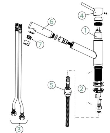
Hinweis: Diese Explosionszeichnung bildet die Hochdruck-Armatur mit deren Ersatzteilen ab. Für die Niederdruck-Armatur finden sie die Ersatzteilnummern in der Anleitung oder in unserem Shop.
